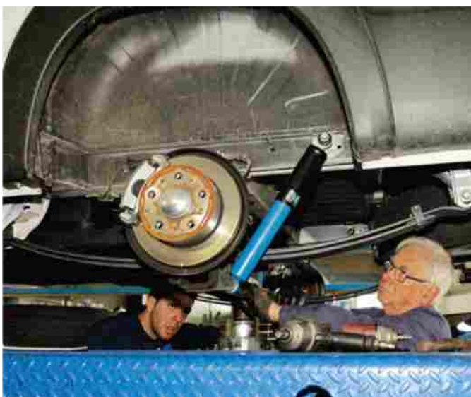
9) Si procede al montaggio dei nuovi ammortizzatori
